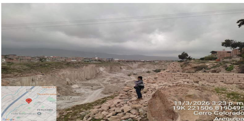
FIGURA N°03: SE OBSERVA EN EL TRAMO EXTRACCION DE SILLAR QUEDANDO LA QUEBRADA COLMATADA CON RESIDUOS PRODUCTO DE LA DETONACION CON DINAMITA ANTE UNA MAXIMA AVENIDA SE PUEDE PRODUCIR UNA INUNDACION AGUAS ABAJO
